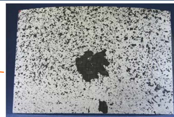
TWINTEX® Platte mit Grauwert-Muster für DIC (Dicke: 8 mm)
