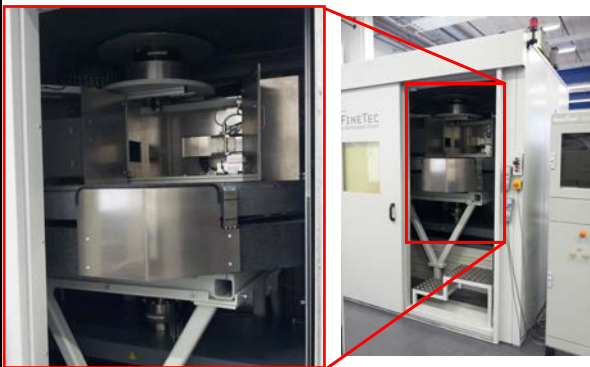
„In situ CT Vorrichtung“ für mehrachsige Belastungen (Zug/Druck und Torsion)
